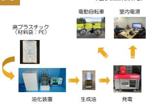
壱武工業所では、製品の製造時に廃棄される 材料袋を卓上油化装置に投入して油を生成し ています。
